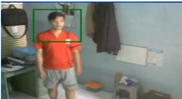
Gambar 14. Hasil deteksi dengan lux 48,96
